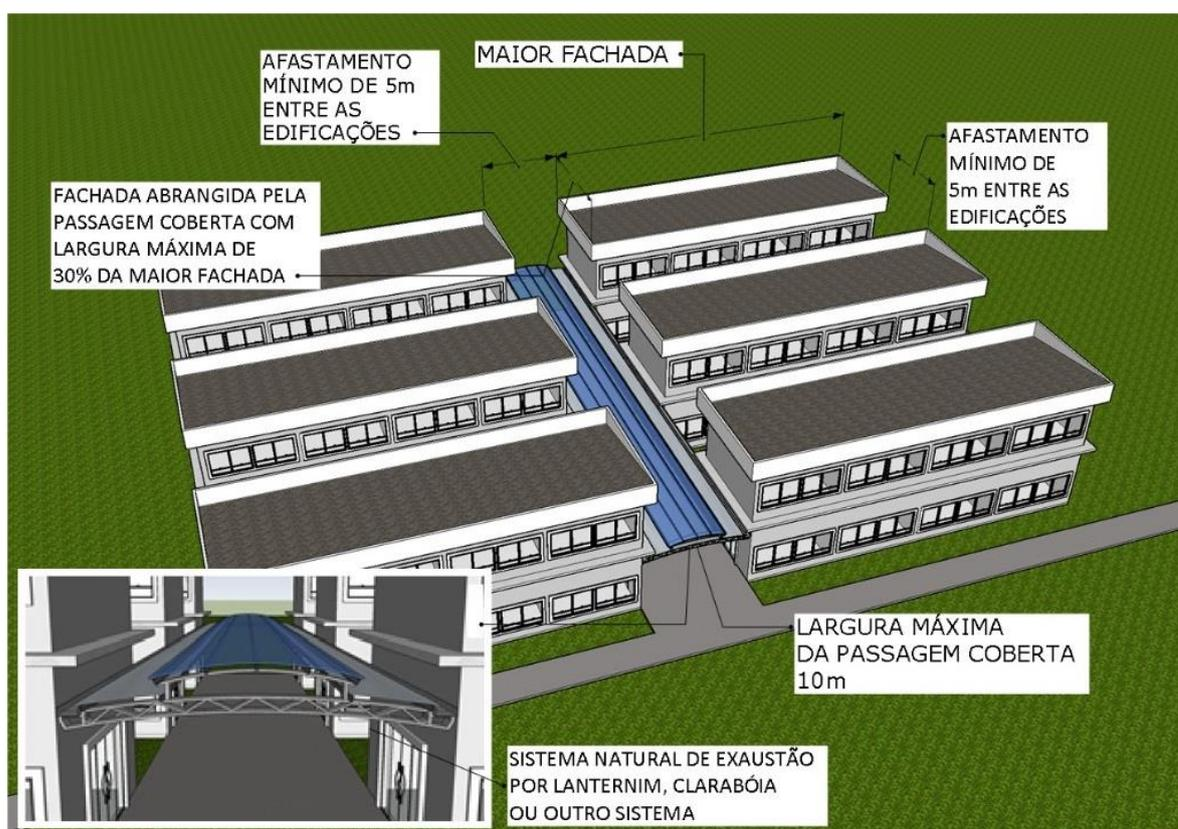
**Figura 22 – Passagem coberta contínua externa ligando mais de uma edificação. Fachada abrangida pela passagem coberta com largura máxima de até 30% da maior fachada**
