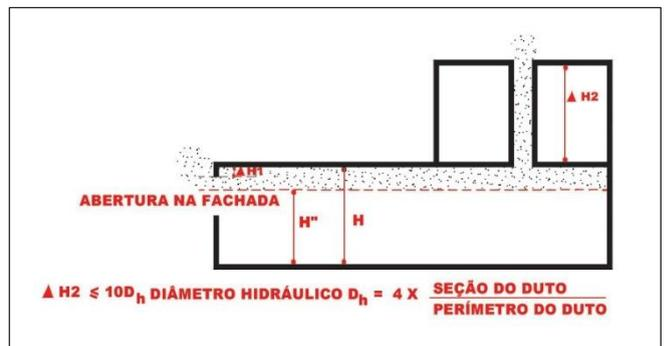
Figura 17: Diâmetro hidráulico
