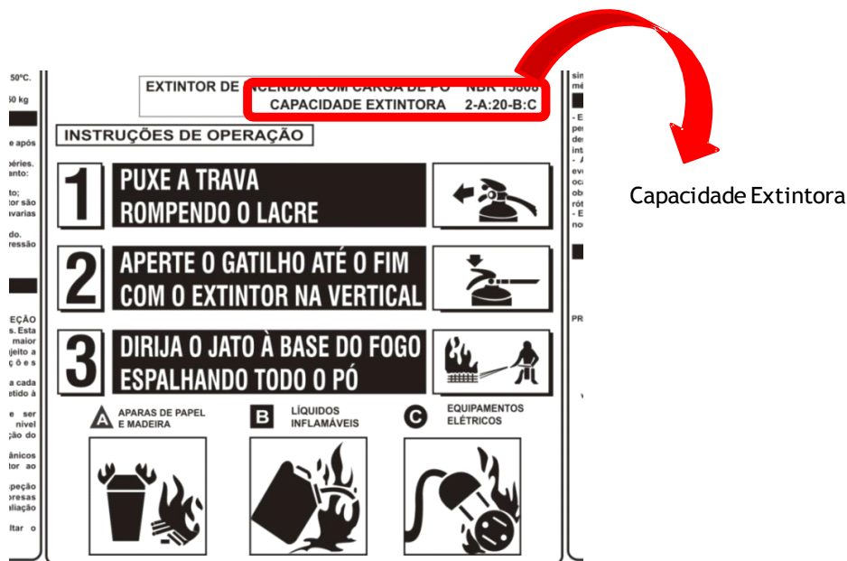
Fig. 30 – Capacidade extintora no quadro de instruções (rótulo) do extintor
