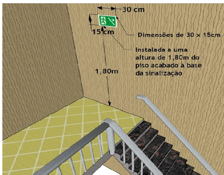
Fig. 43 – Sinalização de escada de emergência
