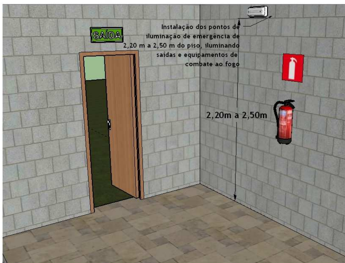
Fig. 49 – Instalação dos pontos de iluminação de emergência
