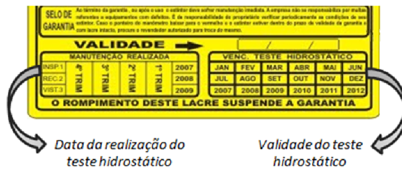
Fig. 37 – Selo de garantia dos extintores de incêndio inspecionados
